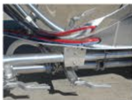
Acceso al cableado y la tubería de aire
