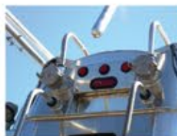
Tuberías de carga y ventilación
