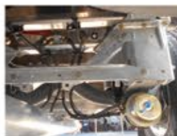
Barras de suspensión galvanizadas y ejes con revestimiento tenue
