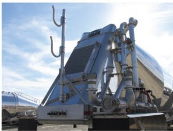
Tubería de aire
